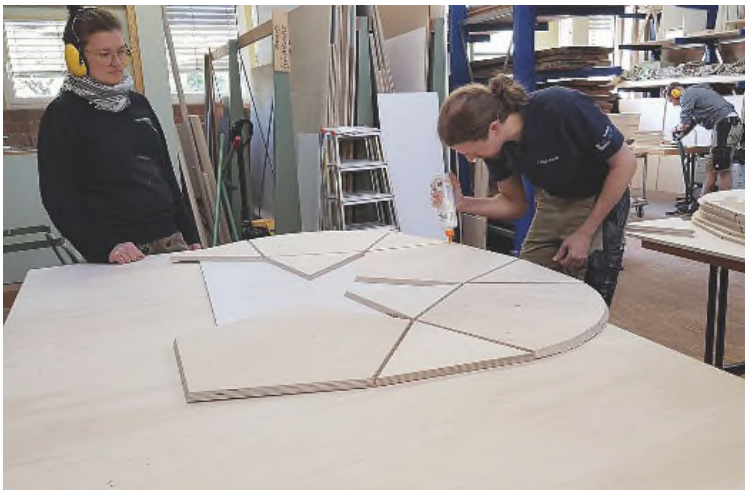
/ Aufwendiges faltwerk: Die Einzelemente wurden von den Meisterschülern und -schülerinnen nach der Winkelbearbeitung mit Klebeband sauber gefügt und ...
