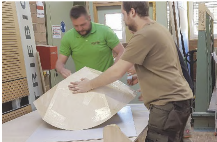
/ ... anschließend mit vereinten Kräften – unter einer Passgenauigkeit, welche die SchülerInnen nicht erwartet hatten – mit PU-Leim zur Sitzschale zusammengefaltet.
