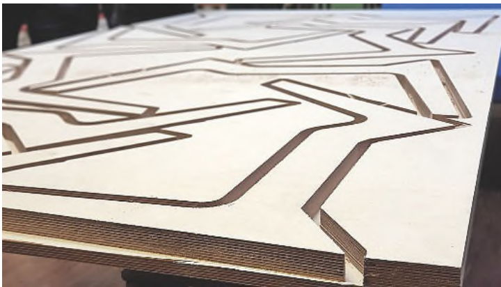
/ Aus dem vollen Material: Im Nestingverfahren konnten die Beine effizient und Material sparend aus der Multiplexplatte herausgefräst werden, ...
