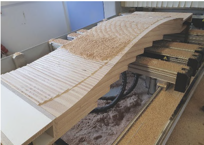
/ Über eigens gefertigte Aufnahmekorpuse wurde das Thekenmittelteil auf der CNC-Maschine fixiert, was eine exakte Bearbeitung der Unterseite gewährleistete.
