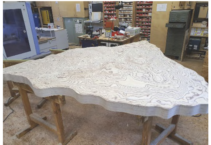
/ Effiziente Landschaftsformung: Das 3 x 2 m große Modell wurde zweiteilig und in mehreren Schritten auf einer Homag Venture 115 M gefertigt.
